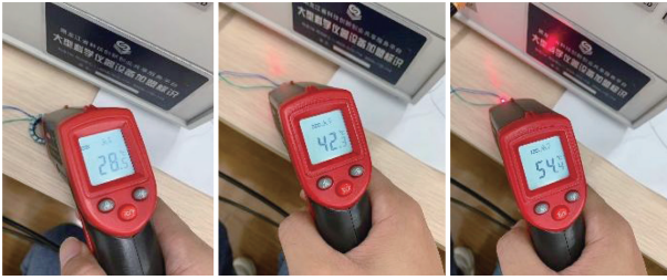
图 3 连续测量导致样品温度上升
